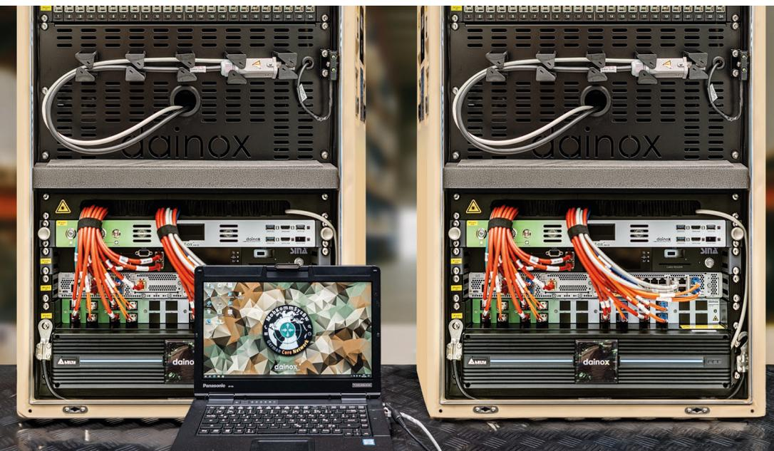
Der Transportservice BTuLB ist ein in sich redundanter und verlegefähiger Netzwerkknoten für das MobKommSys Kernnetz im Einsatzgebiet. Er rundet als „kleiner Systemtrupp“ das Portfolio im verlegefähigen Bereich „nach unten“ ab und ermöglicht durch die geringeren logistischen Aufwände eine schnellere Inbetriebnahme an einem Einsatzstandort.
